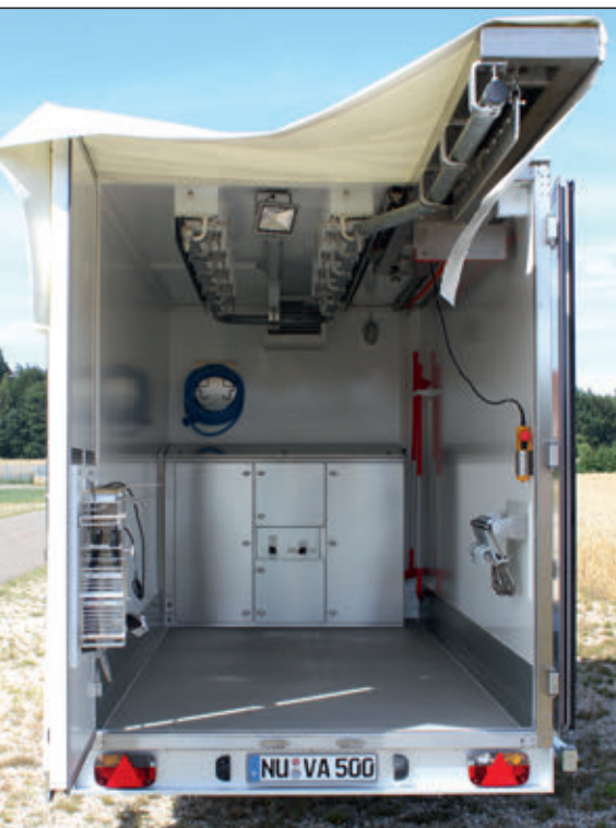
Innenansicht des voll ausgestatteten Wildanhängers mit herausgefahrener Aufbrechstation ▲
