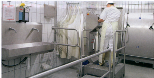
Das Personal durchläuft in der Hygieneschleuse idealerweise eine Zwangsführung, die sicherstellt, dass alle Schritte in der geforderten Reihenfolge und Dauer durchgeführt werden. | Foto: egs
