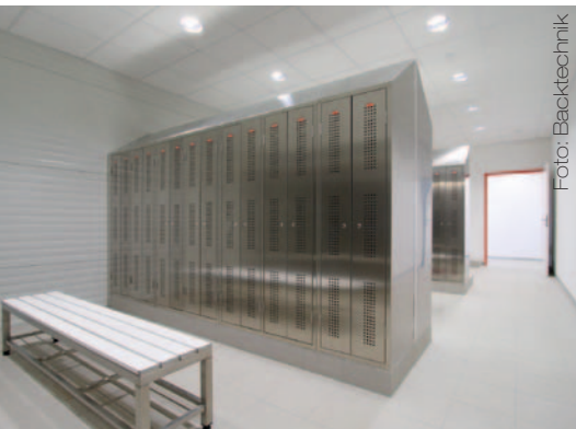
Bild links: Das Dach der Spinde ist bewusst schräg gehalten, damit die Mitarbeiter es nicht als Ablageplatz nutzen können. Bild rechts: Die Seifenmenge ist über die Programmierung der Steuerung veränderbar. Alle gängigen Seifen lassen sich über den Seifenspender der Friedrich Sailer GmbH verarbeiten.
