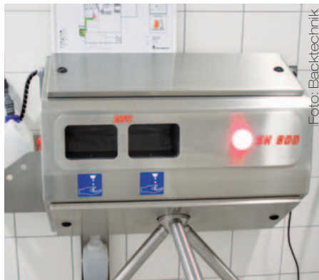
Bild links: Das Dach der Spinde ist bewusst schräg gehalten, damit die Mitarbeiter es nicht als Ablageplatz nutzen können. Bild rechts: Die Seifenmenge ist über die Programmierung der Steuerung veränderbar. Alle gängigen Seifen lassen sich über den Seifenspender der Friedrich Sailer GmbH verarbeiten.
